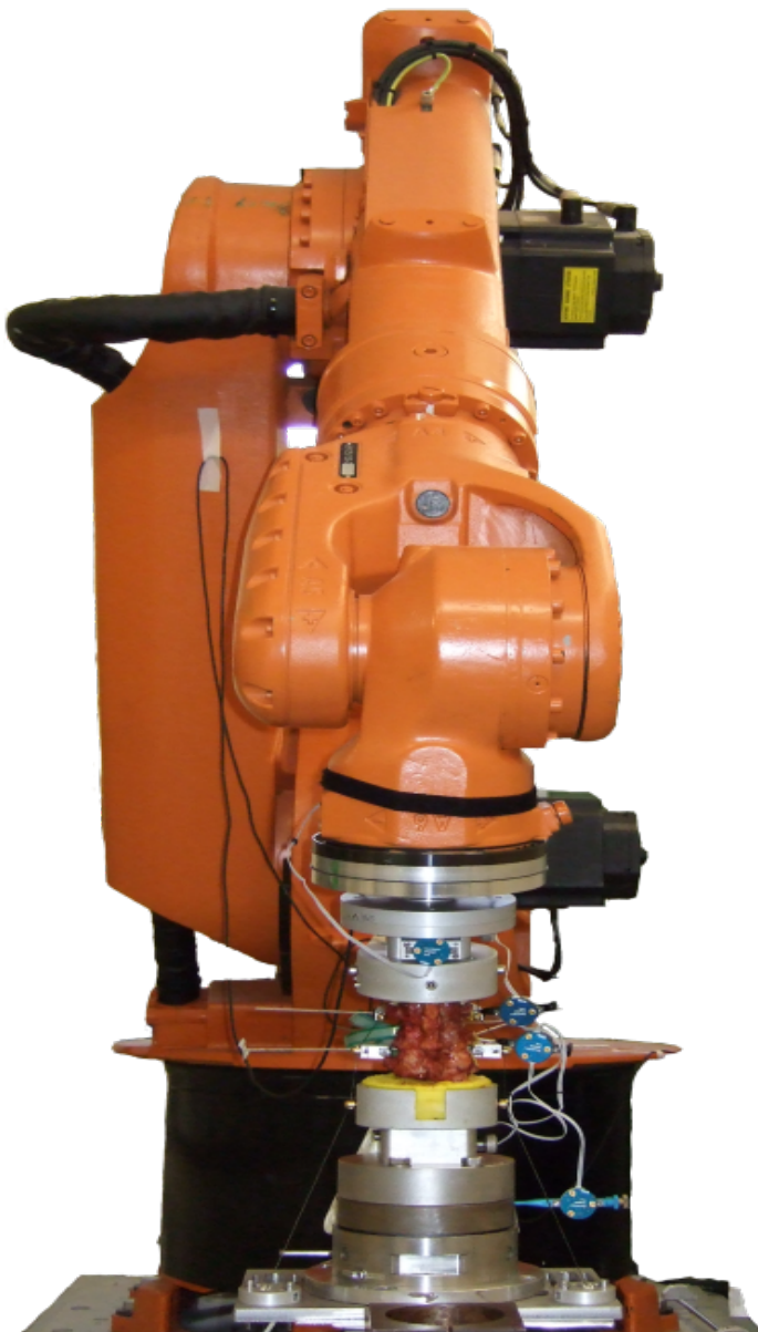
Abbildung 27: Multisegmentales Wirbelsäulenpräparat im robotergestützten Prüfstand.
